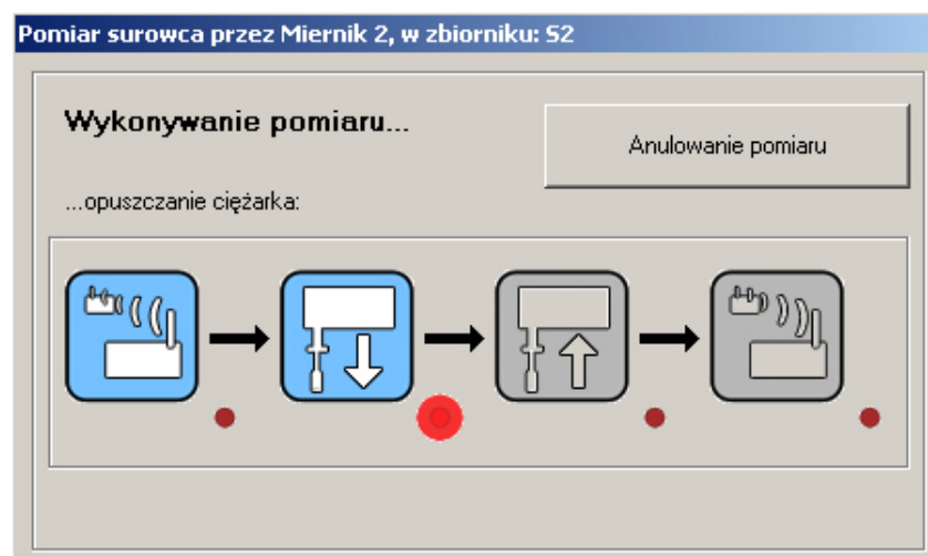
Rys. 28: Wykonywanie pomiaru – ciężarek opuszczany w dół.
