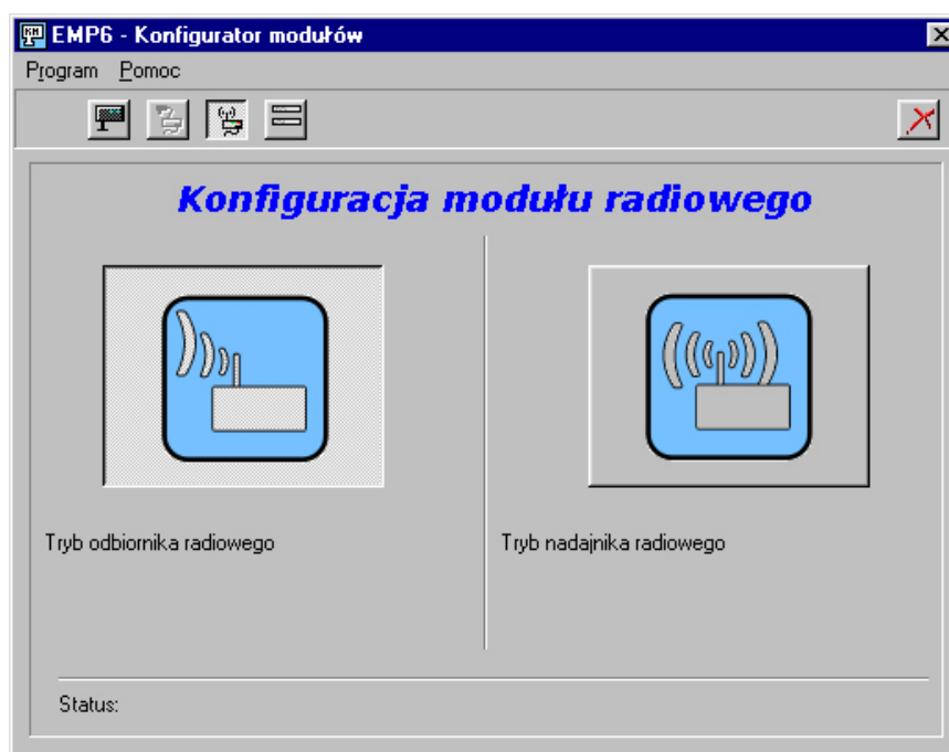
Rys. 9: Okno Konfiguratora modułów podczas ustalania trybu pracy modułu radiowego.
