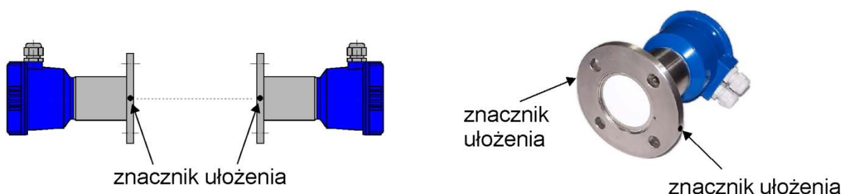
Rys.8. Wzajemne ułożenie nadajnika i odbiornika sygnalizatora MSPB-1.
